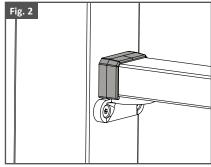
Paso 2: Instalar cubiertas para bases para postes y tapas piramidales planas/de bola
